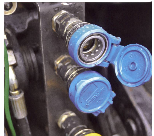
Praktisch: Schnelkupplungen für hydraulisch angetriebene Anbaugeräte – diese Schnittstellen sind immer vor Wasser und Schmutz zu schützen.
