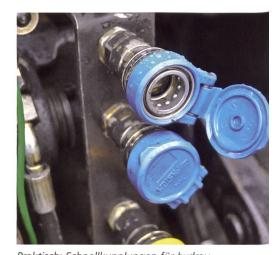
Praktisch: Schnellkupplungen für hydraulisch angetriebene Anbaugeräte – diese Schnittstellen sind immer vor Wasser und Schmutz zu schützen.
