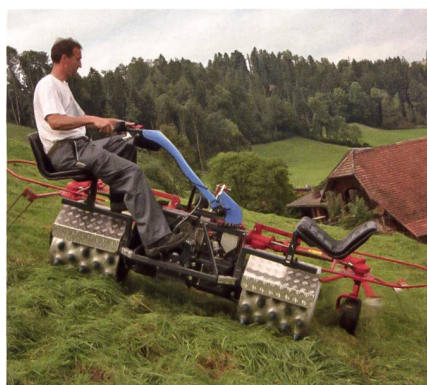
Kreiselheuerkombination mit Sitzgelegenheit auf dem Brielmaier-Motormäher Hydro.
