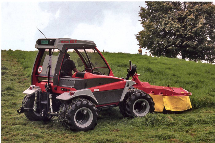
Neue Serie der Reform-Zweiachsmäher als geschaltete G5X-Serie bzw. auch als hydrostatische H5X-Serie im Programm.
