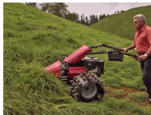
Köppl-Hydromäher mit aufziehbaren HillSpikes.
