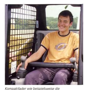
Modelle von Bobcat sind schon seit Langen mit einer sicheren Kabine und einem zwangsweise wirkenden Rückhaltesystem ausgerüstet. Dadurch bleibt der Fahrer immer innerhalb der sicheren Kabinenkonstruktion.
