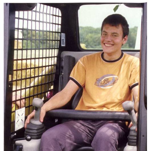
Kompaktlader wie beispielsweise die Modelle von Bobcat sind schon seit Längen mit einer sicheren Kabine und einem zwangsweise wirkenden Rückhaltesystem ausgerüstet. Dadurch bleibt der Fahrer immer innerhalb der sicheren Kabinenkonstruktion.
