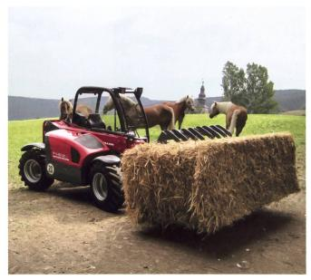
Um Teleskoplader auch in engen Verhältnissen einzusetzen, bieten die Hersteller inzwischen auch kompakt gebaute Lader an, die in Zukunft den einen oder anderen Hoflader ersetzen können. Hohe Hubhöhe bei kompakten Aussenmassen lautet die Devise.
