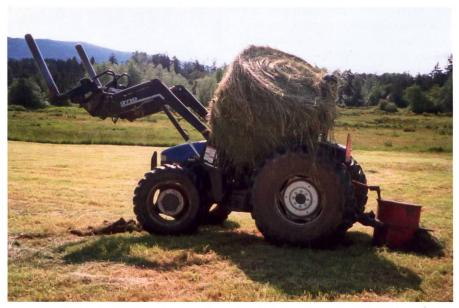
Traktoren ohne Kabine sollten nicht mit einem Frontlader ausgerüstet werden. Die Gefährdung ist dieselbe wie beim Hoflader ohne Fahrerschutzdach.
