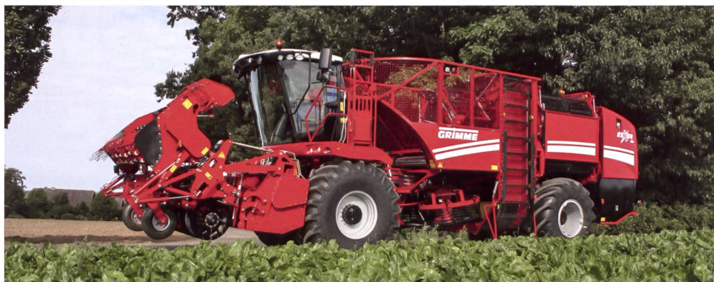
Hochgeklappter Entblätterer und Köpfer verringert den vorderen Überhang auf der Strasse.
