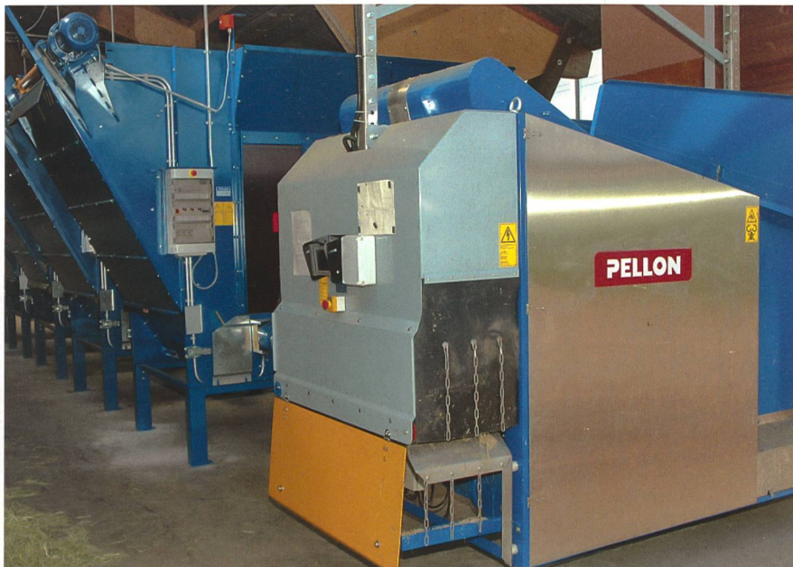
Die Beschickung der verschiedenen Vorratsbehälter (im Hintergrund) geschieht bei ART durch die geöffnete Rückwand des Stalles. Der Roboter steht in Parkposition.
