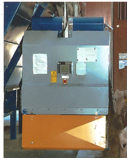
Der Fütterungsroboter von ART ruft die notwendigen Mengen vom Vorratsbehälter ab und füttert mehrere Tiergruppen mit unterschiedlichen Rationen bis zu 10 Mal am Tag.
