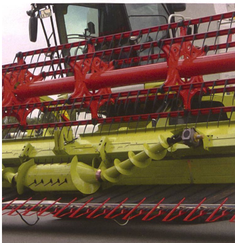
MAXFLOW-Schneidwerk: Transportbänder befördern das Erntegut zum Einzugskanal
