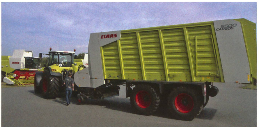
Kombiwagen Cargos mit um 500 mm ansteigendem Kratzboden. Für den Betrieb als Häckselwagen können die Aggregate für das Be- und Entladen innert 15 Minuten demonstrierbar werden. Neuerdings kann man den Anhänger auch mit einem sehr genauen Wiegesystem ausrüsten.
