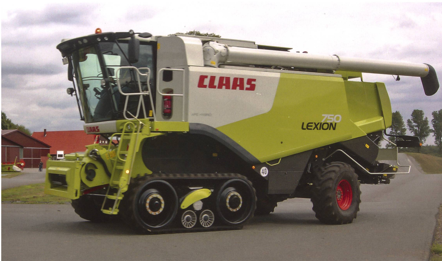
Die neue Lexion 700 Hybrid-Serie präsentiert sich augenfällig mit einem federungstechnisch optimierten Raupenlaufwerk. (Bilder Ueli Zweifel)
