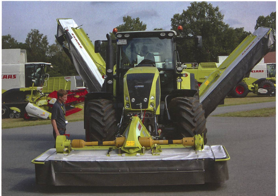
Neues Mähwerk mit Rollenaufbereiter mit hydropneumatischer Entlastung «Active Float».
