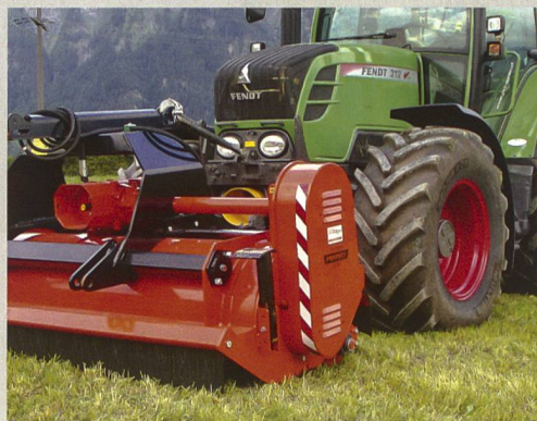
Beschleunigte Metallteile oder Steine werden von einem schützenden Vorhang aus pendelnden Metallplatten abgefangen (im Bild schwarz).
