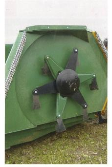
Die Messer dieses horizontal arbeitenden Mulchers schneiden auf zwei unterschiedlichen Höhen, dadurch wird der Mulcheffekt verbessert.
