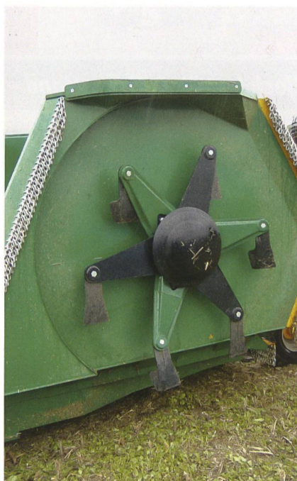
Die Messer dieses horizontal arbeitenden Mulchers schneiden auf zwei unterschiedlichen Höhen, dadurch wird der Mulcheffekt verbessert.
