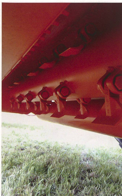
Hammerschlegel zerschlagen die Erntereste. Zusätzlich dient der an der Haubenkante montierte Reisskamm einer weiteren Zerkleinerung.
