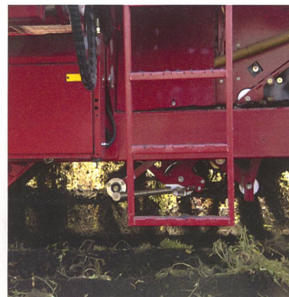
Die Transportbänder müssen so eingestellt werden, dass bei der Übergabe noch eine feine Erdschicht vorhanden ist.
