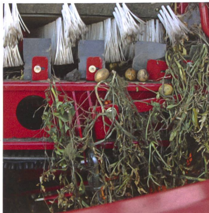
Zum Stand der Technik gehört eine effiziente Krautabscheidung.
