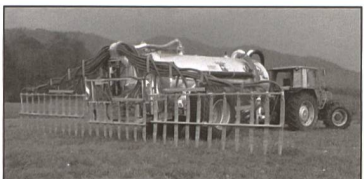
Fassverteiler passt an jedes Vakuum- oder Pumpfass.
