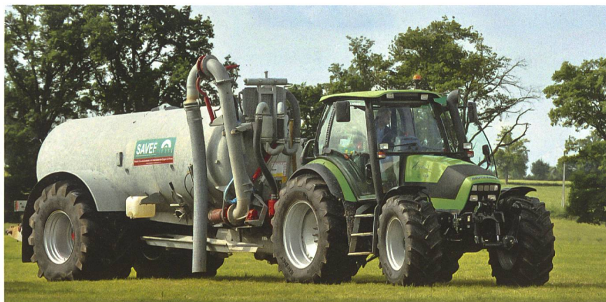
Durch die Verkleinerung des Nabendurchmessers und durch die Pneuverbreiterung gelingt es, die Reifentragkraft zu steigern, ohne den Bodendruck zu erhöhen.
