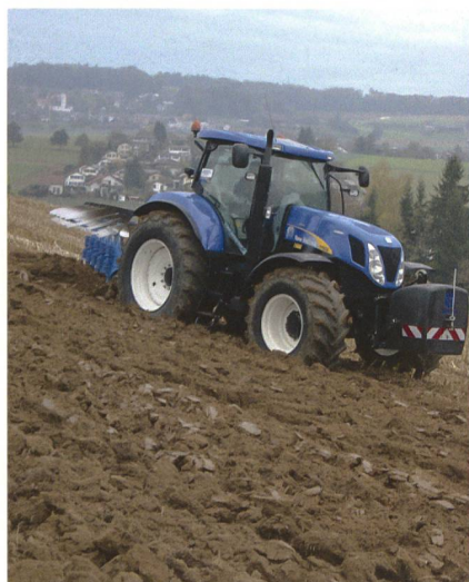
Die richtige Gewichtsverteilung auf den Traktor erhöht die Zugkraft.
