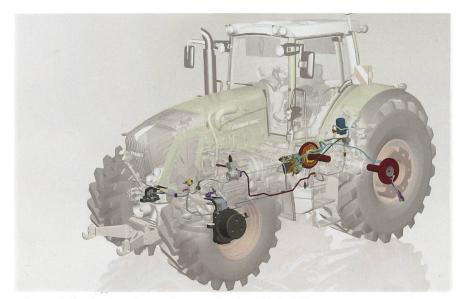
Schema: Reifendruckregelungsanlage auf den Fendt Vario 900.
