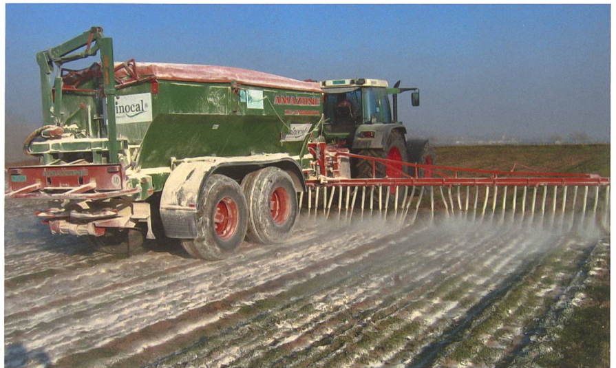
Optimale Verteilung des Kalksteinmehls mit dem Schnecken-Düngerstreuer. (Foto: Briner AG, Hagenbuch ZH)
