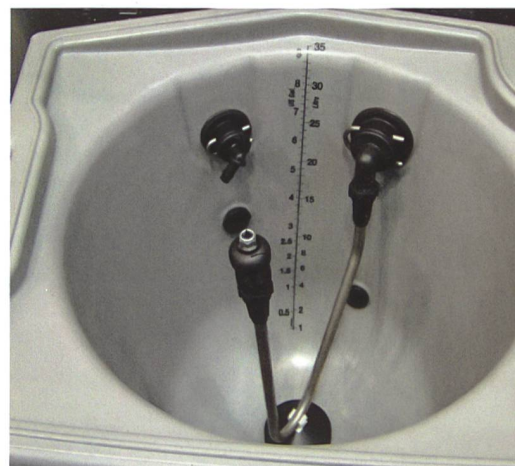
Ein Einfüllbehälter erleichtert die Arbeit des Spritzenführers wesentlich und bietet Gewähr, dass die Pflanzenschutzmittel optimal aufgelöst und eingemischt werden.
