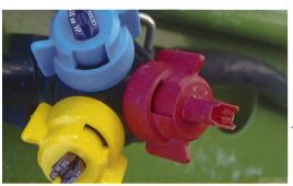
Mit Mehrfachdüsenträgern kann rasch und sicher die richtige Düse gewählt werden. Kunststoffdüsen haben bereits zu Beginn des Einsatzes sehr gute Werte. Mit zunehmender Einsatzfläche nimmt der Verschleiss an einem Düsenmundstück zu.
