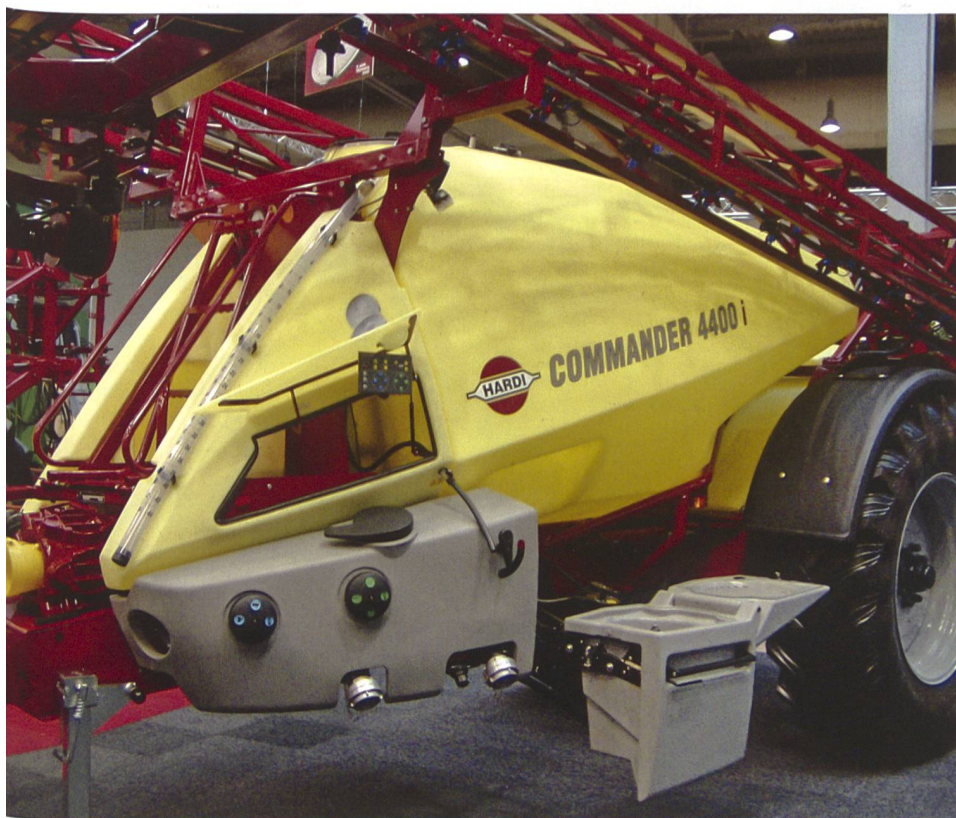
Hackfruchtbetriebe benötigen grosse Flüssigkeitsmengen pro Hektar, dazu bieten sich Anhängespritzen an. Sie haben mehr Volumen als Anbauspritzen und in der Regel grössere Arbeitsbreiten.
