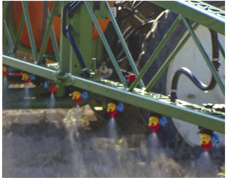
Injektordüsen verhindern weitgehend, dass Abdrift entsteht, welche für Umwelt und Nachbarkulturen schädlich ist.
