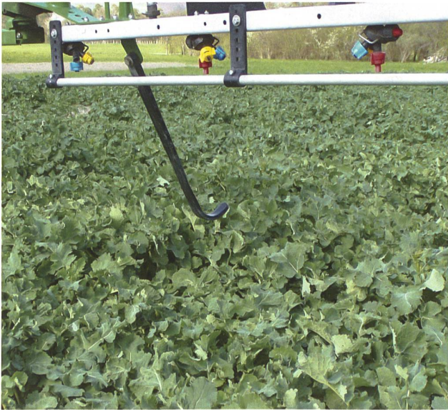
Die Distanz zur Zielfläche muss immer dieselbe sein, sei dies nun ein unbewachsener Boden oder eine wachsende Kultur.
