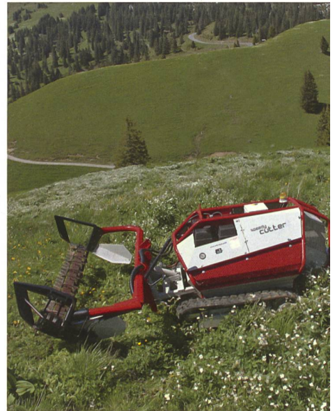
Die Fernbedienung ermöglicht es dem Benutzer des Speedy Cutters, sich ausserhalb der Gefahrenzone aufzuhalten.
