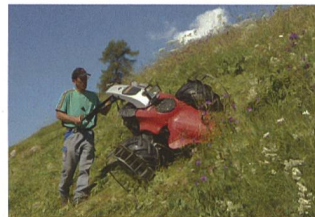
Combicut Aebi CC66: Der hydrostatische Komforteinachser mit Aktivlenkung.
