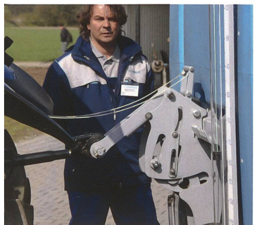
Das QuickConnect-System macht das Ankoppeln von Feldspritzen zum Kinderspiel.
