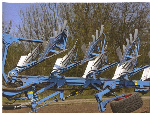
Alle Einstellungen der neuen Juwel-Pflüge können direkt von der Traktorkabine aus vorgenommen werden.
