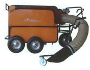
Eco Cure ist eine Allzweckmaschine zur Bearbeitung von Sportplätzen und grösseren Rasenflächen, welche von einem Kommunaltraktor gezogen werden kann. Der Allessauger Cameleon light (Bild) mit dem integrierten Häcksler und einem 700-Liter-Auffangcontainer wird überall dort eingesetzt, wo Sträucher geschnitten, Grünabfall
