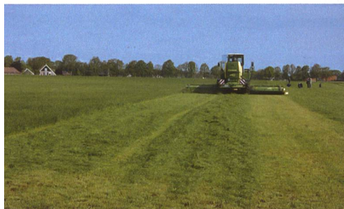
Big M400 mit Trippelmähwerksaufbereiter zeigt die Möglichkeit der Teilbreitenablage des Futters. Es sei vermerkt, dass der Futteraufwuchs anlässlich der Demonstration schwach war, weil es zu wenig geregnet hatte.
