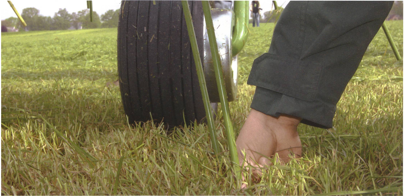
Kreiselzettwender: Zwei Finger breit Abstand vom Boden sichert sauber gewendetes Futter. (Fotos: Ueli Zweifel)
