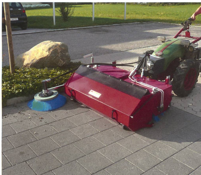
Neue Nutzungsmöglichkeit für den Motormäher dank der grossen Zahl von Zusatzgeräten. (Foto: EMS)
