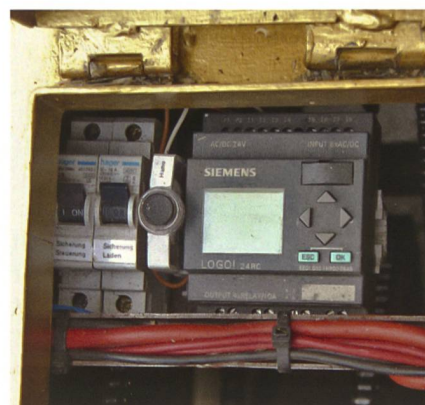
Das Herz der Futterkrippe ist die elektronische Steuerungseinheit.
