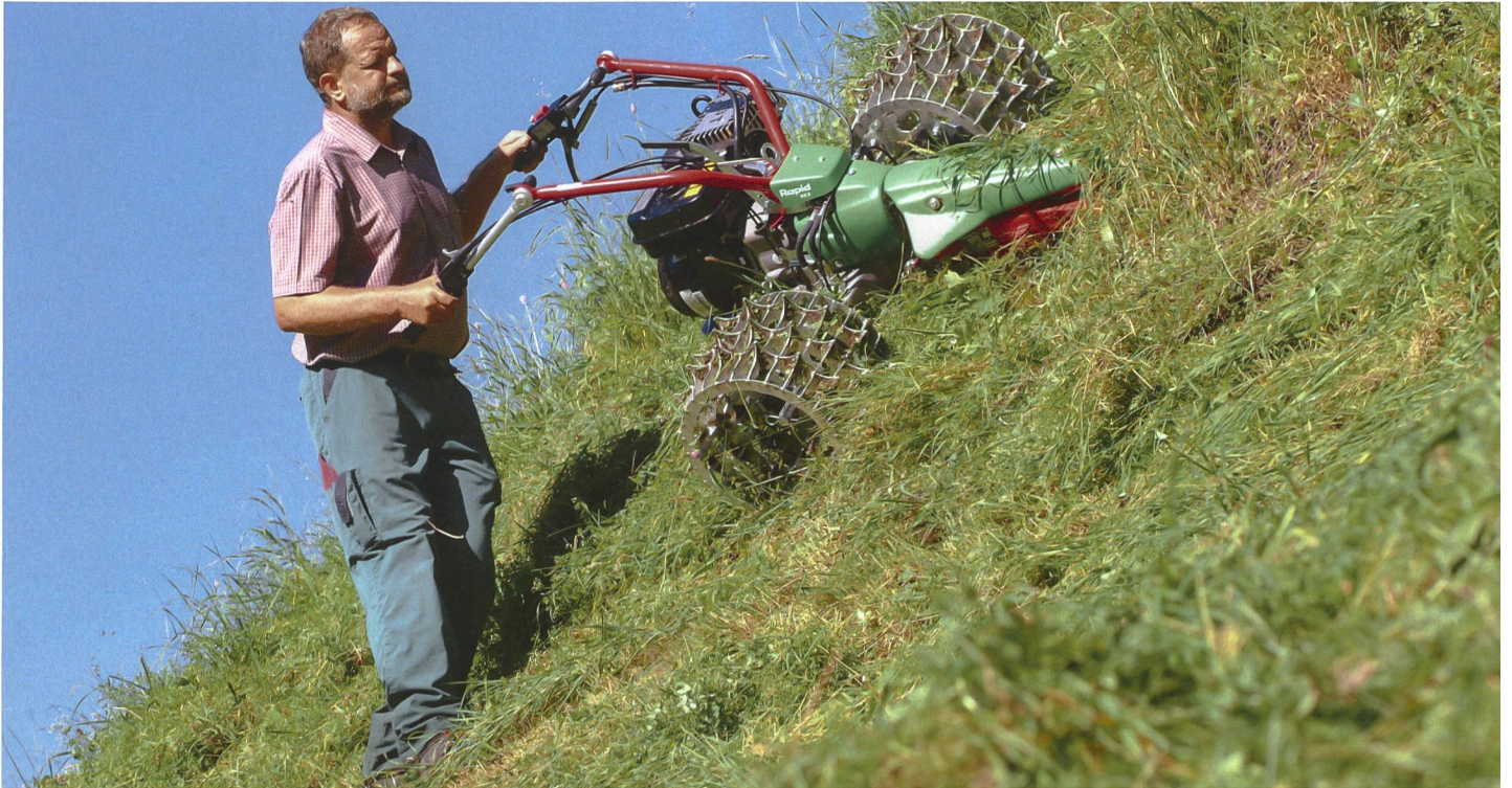
Stufenloser Fahrtrieb, hydrostatische Lenkung, hydraulische Kraftübertragung: Die Einachsmäher haben die meisten Entwicklungen auf dem Traktor auch mitgemacht. Im Bild der neue Rapid REX (Foto: zVg).
