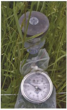
Mit Tensiometern wird die Wasserspannung im Boden gemessen. Mit einem Netz von Messpunkten kann eine Aussage zur Verfügbarkeit von Wasser gemacht werden.
