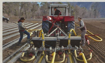
Mit der von Werkstattchef Christian Berther in vielen Arbeitsstunden konstruierten Maschine werden gleichzeitig Dämme geformt und Schlauchmaterial verlegt.
