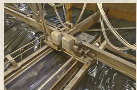
Deutlich erkennbar ist das Zahnrad am Motor, das in die Lochschiene greift. Damit ist jederzeit die Position exakt bestimmbar. Bei gummierten Rollen ist eine aufwendige Steuerung oder eine Steuerung nach Sicht erforderlich. Bild 4: Zuführende Fördertechnik und Hauptverteillband
