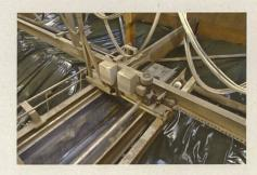
Deutlich erkennbar ist das Zahnrad am Motor, das in die Lochschiene greift. Damit ist jederzeit die Position exakt bestimmbar. Bei gummierten Rollen ist eine aufwendige Steuerung oder eine Steuerung nach Sicht erforderlich. Bild 4: Zuführende Fördertechnik und Hauptverteilband
