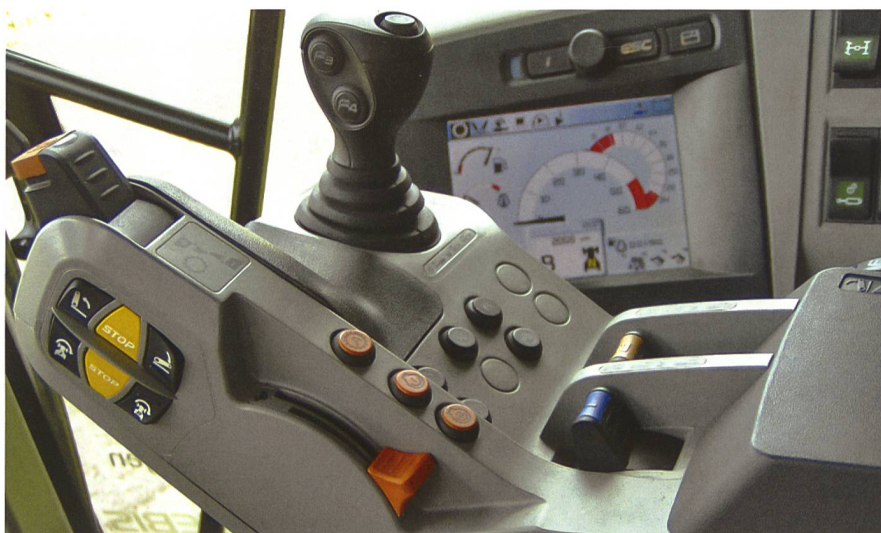
Die Multifunktionsarmlehne mit der Bedienung für das Heckhubwerk und dem Vorgewendemanagement sowie dem Drivestick für das Hexashift-Getriebe.
