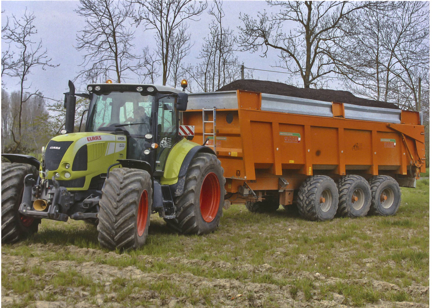
Am Limit des zulässigen Gesamtgewichtes dank optimaler Verteilung des Anhängergewichtes auf den Traktor (Stützlast) und auf die Achsen des Anhängers (Anhängelast). (Foto: Gaël Monnerat)
