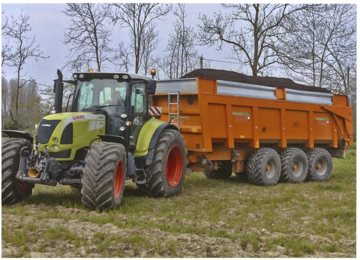
Am Limit des zulässigen Gesamtgewichtes dank optimaler Verteilung des Annhängergewichtes auf den Traktor (Stützlast) und auf die Achsen des Anhängers (Anhängelast). (Foto: Gaël Monnerat)
