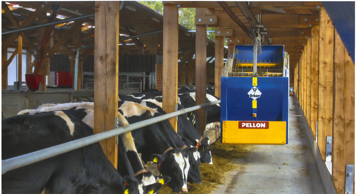
Schienengeführtes Fütterungssystem bei der Futtermulde (Pellon).
