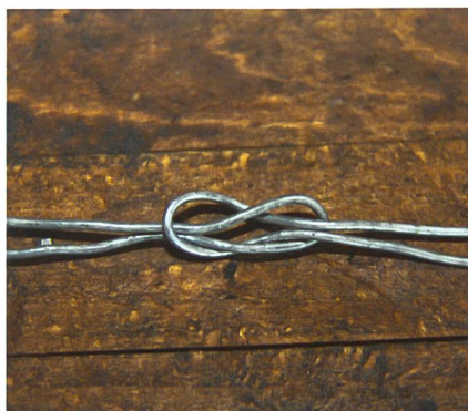
Ein flacher Knoten (links) gewährleistet einen besseren Kontakt als die Verschlaufung rechts.
