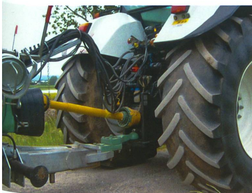
Kugelpopf-Untenanhängung: Verlagerung bis maximal drei Tonnen Stützlast auf den Traktor (unter Beachtung der Randbedingungen gemäss Beitrag Seite 34).
