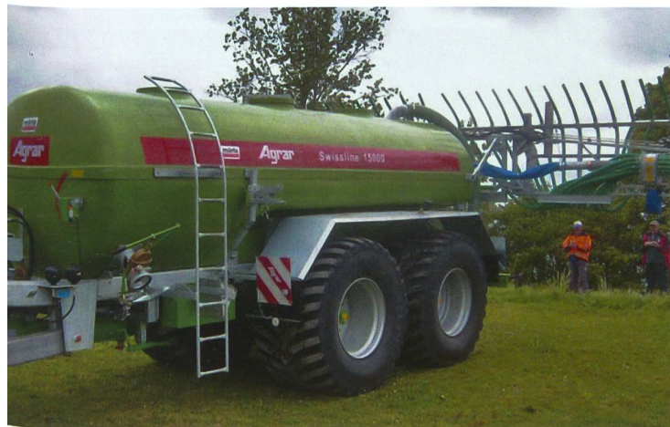
Einphasiges Verfahren: Flexibilität bei Transport und Ausbringung dank Fassungsvermögen, bodenschonendem Fahrwerk und Schleppschauchverteilssystem.
