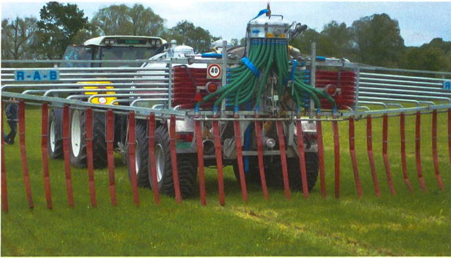
Damit die Gülle und ihre Inhaltsstoffe dorthin kommen, wo man sie haben will: mit Schleppschlauchverteiler als Standardlösung oder ...
