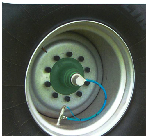
Reifendruckregelanlage für den optimalen Reifendruck auf der Strasse und im Feld.
