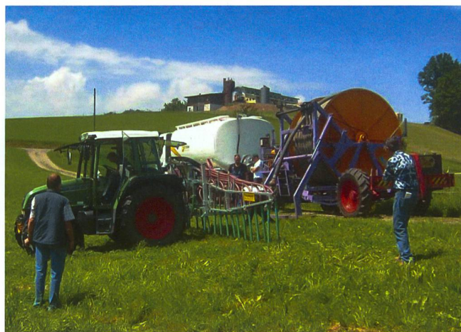
Zweiphasiges Ausbringungsverfahren: Logistik am Feldrand bei maximaler Transportleistung mit LKW und minimaler Bodenbelastung mit Schleppschauchverteiler.
