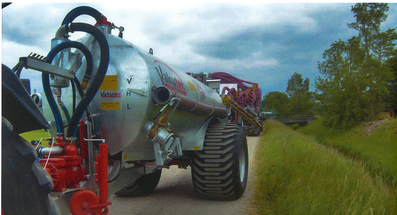
Im Trend: mehr Nutzlast, weniger Bodendruck dank Breitbereifung, bessere Dosiergenauigkeit. (Fotos: Strickhof)
