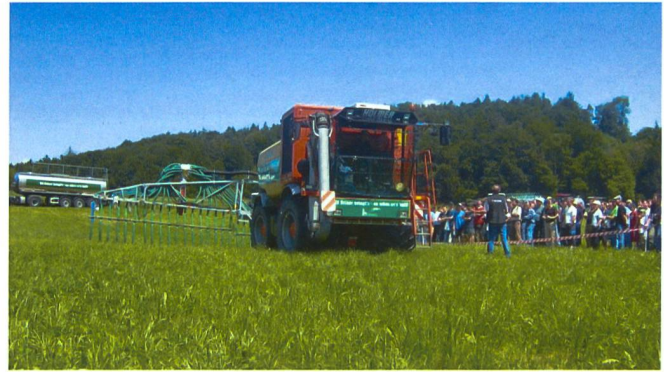
... Selbstfahrer mit Güllebeschickung vom Feldrand.
