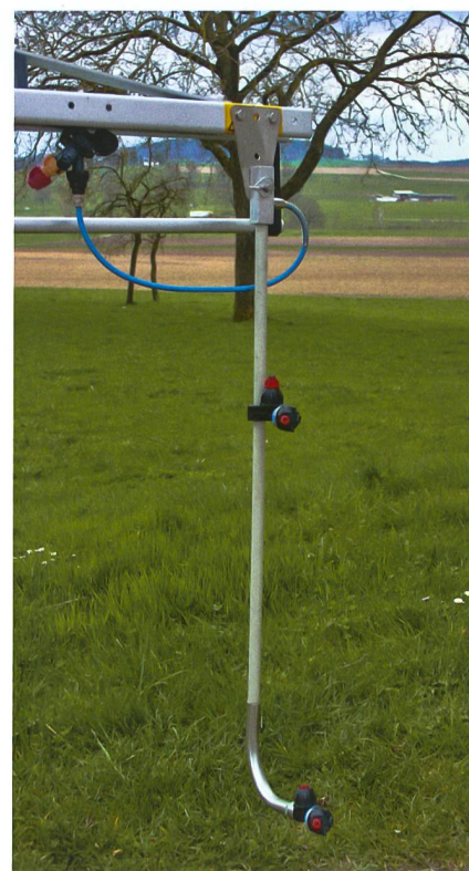
Droplegs mit zusätzlichen, manuell zuschaltbaren Düsen in rund 60 cm Höhe.
