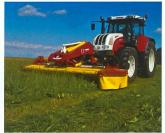
herkömmlichen Anbauböcken, wo nur der Zuglenker auf Bodenunebenheiten reagiert, passt sich beim Anbaubock Alphamotion der gesamte Tragrahmen dem Boden an. Zwei gross dimensionierte, im Anbaubock integrierte Federn bewirken eine gleichmässige Mähwerks-Ent-
