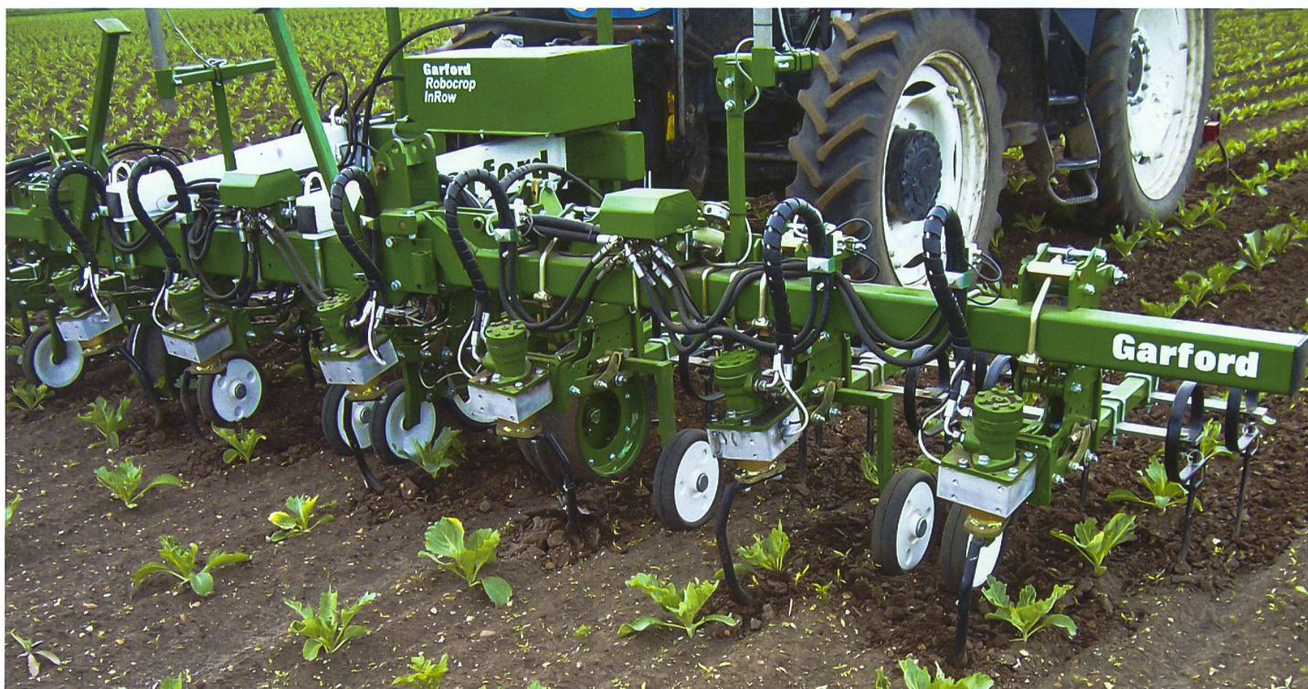
System Robocrop InRow zur sensorgesteuerten Unkrautbekämpfung in den Reihen. (Werkbild)
