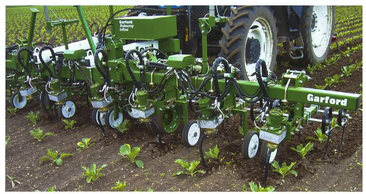
System Robocrop InRow zur sensorgesteuerten Unkrautbekämpfung in den Reihen. (Werksbild)
