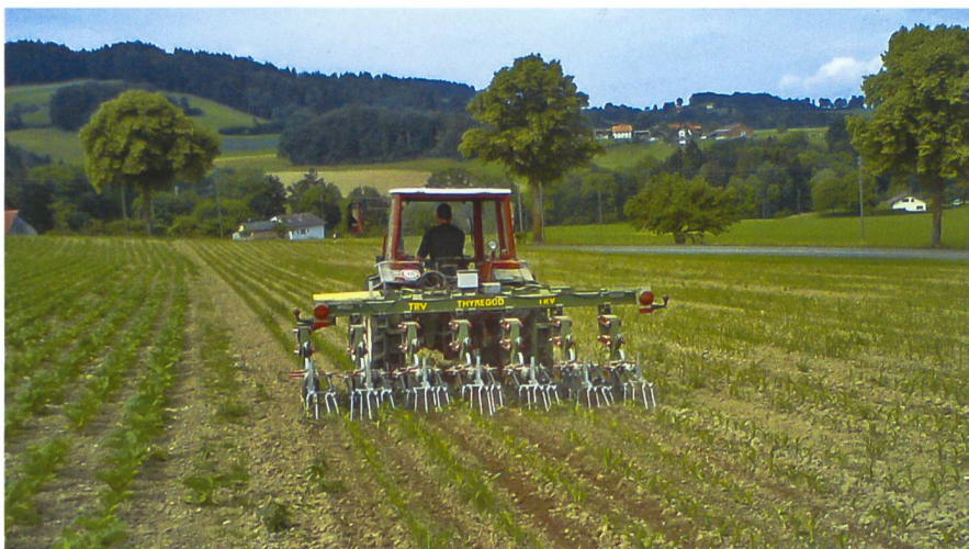
Dank Steuerung mit Kamera kann der Mais ohne zweite Bedienperson gehackt werden.
