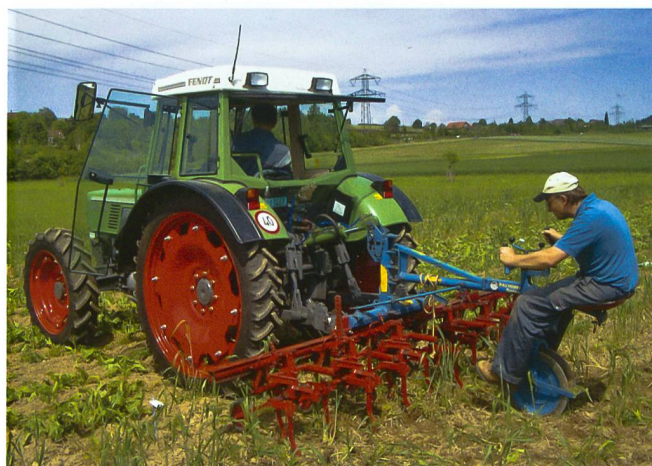
Einsatz eines Scharhackgerätes quer zu den Rübenreihen.
