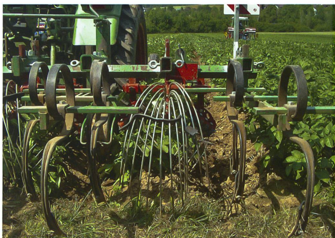
Kombiniertes Hackgerät für Kartoffeln: Hackscharen zwischen den Dämmen, kleine Striegelelemente auf dem Damm.
