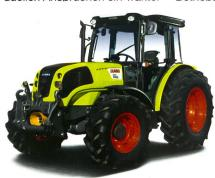
in kompakter Bauweise geschaffen. Die Baureihe umfasst drei Modelle von 72 bis 88 PS. Mit bis zu drei Hydraulikpumpen und einer Hydraulikleistung von max. 85 l/min eröffnet der ELIOS neue Möglichkeiten. Es stehen vier Getriebevarianten zur Auswahl: 12V/12R oder
