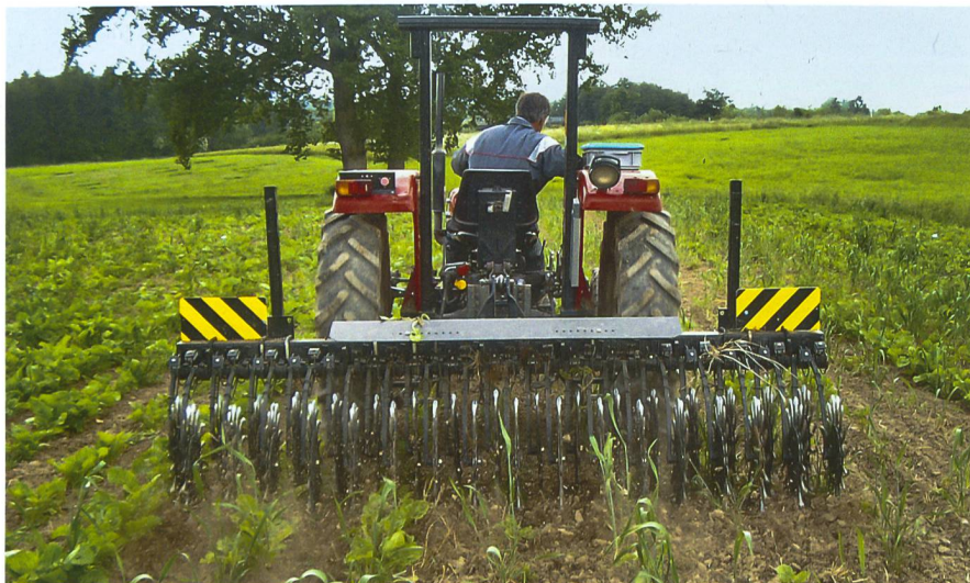
Einsatz einer Rotorhacke «Yetter» in Zuckerrüben.
