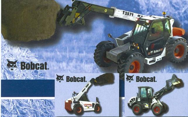
**z.B. Teleskoplader T3571 HD von Bobcat:** Die Z-Kinematik am Ausleger garantiert höchste Reisskraft, Hubhöhe 7,1 m, max. Hubkraft 3,5 t.
