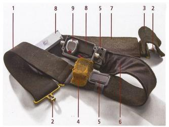
Abb. 4a: Aufbau des Gurtsystems zur Erfassung der Herzfrequenz; 1) elastischer Gurt; 2) Verschluss mit 3) Filzunterlage; 4) Schwamm; 5) zusätzliche Kontaktfläche; 6) Stoffbahn mit darunter liegendem Draht; 7) Filzüberzug; 8) Aluminiumgehäuse mit Deckel; 9) Empfänger Polar S810i. (Foto: ART)
