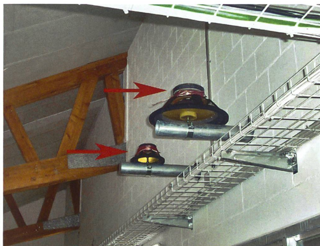
Abb. 1: Lautsprechersysteme zur Erzeugung definierter Lärm- und Körperschallintensitäten. (Foto: ART)
