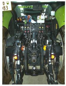
Traktorheck: alles für den Acker- und Schleppereinsatz. Am oberen Bildrand sind der Spiegel und die Bedienung des Hydraulikzylinders für den Oberlenker erkennbar.
