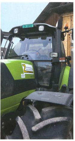
Kraftpaket TTV 620: Serienmässig wir die Luft zum Vorteil des Luftfilters auf der Höhe des Kabinendaches angesaugt.
