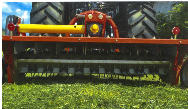
Am stärksten verbreitet sind Zinkenaufbereiter. Doch unterscheiden sich diese stark durch die Zinkenwahl. (Bilder: Fella und Agriott)
