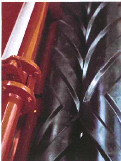
Walzenaufbereiter können vor allem dann ihre Wirkung haben, wenn das Futter auf der ganzen Arbeitsbreite abgelegt werden kann. (Bild: Kuhn)
