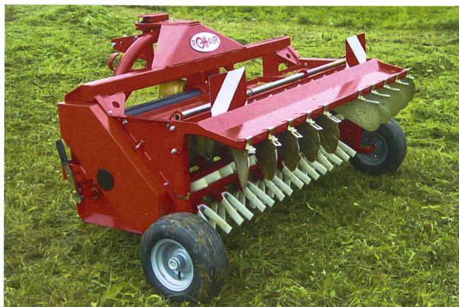
Am stärksten verbreitet sind Zinkenaufbereiter. Doch unterscheiden sich diese stark durch die Zinkenwahl. (Bilder: Fella und Agriott)
