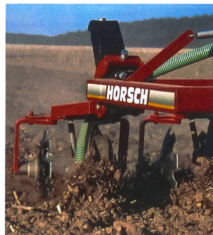
Strip tillage wurde in den USA entwickelt und kommt langsam nach Europa. Im Herbst oder Frühjahr werden Streifen gelockert. Der Mais wird schliesslich in diese Streifen gesät. Ziel sind schnellere Erwärmung der Böden und Förderung der Jugendentwicklung des Mais. (Foto: Fa. Horsch, D-Schwandorf)
