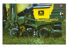
Direktsaaten bewähren sich bei guter Bodenstruktur und zeichnen sich durch besten Erosionsschutz, tiefsten Energiebedarf und tiefste Kosten aus. (Fotos: T. Anken)
