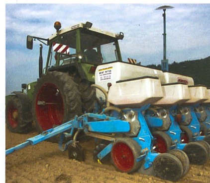
Konventionelle Einzelkornsätechnik: tausendfach bewährt. (Bild: Ueli Zweifel)
