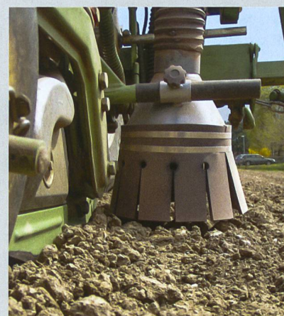
Deflektoren sollen die Abluft der pneumatischen Einzelkornsämaschine unmittelbar über die Bodenoberfläche ableiten. (Bild: Ruedi Hunger)
