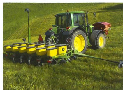
Bei der Direktsaat wird mittels Scheiben-, Meissel- oder Kreuzschlitz-Särscharen lediglich ein Schlitz im Boden geöffnet und nach der Saatgutablage geschlossen. (Bild: Hanspeter Lauper)
