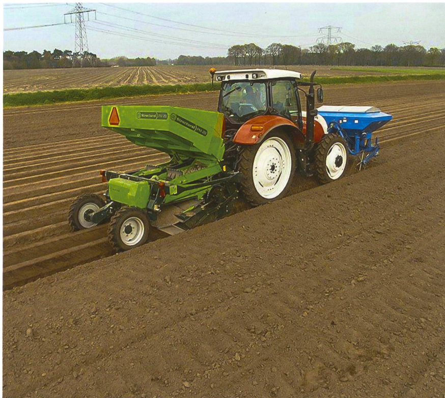
Geringe Knollenfallhöhe: wichtige Eigenschaft der Riemenpflanzmaschinen.
