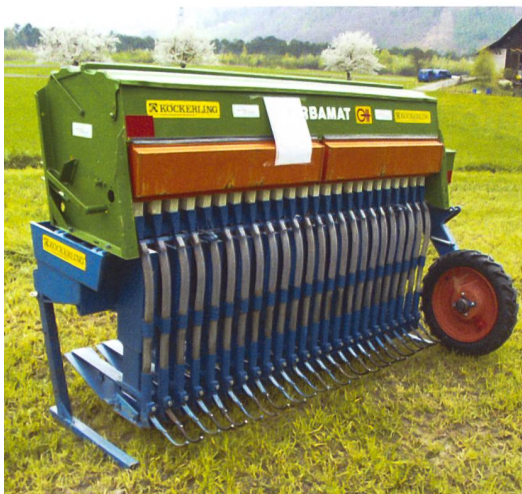
Der Herbatmat sichert dem Saatgut guten Bodenkontakt. Dank einfacher Handhabung ist das Gerät problemlos überbetrieblich einsetzbar.
