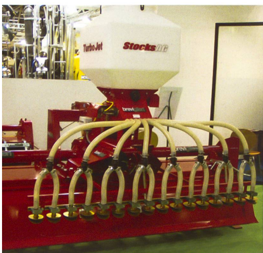
Die Kombination von Rotoregge und Sägerät eignet sich für Flickarbeit auf kleinen Flächen.
