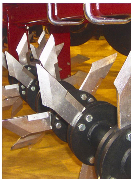
Stark verfilzte Wiesen- und Weideflächen werden durch diese Messer zerschnitten, und damit wird Platz für Saatgut geschaffen. Allerdings bleibt der Konkurrenzdruck der noch bestehenden Grasnarbe gross.
