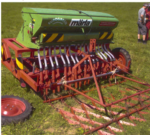
Diese Kombination von verschiedenen Maschinenelementen verschafft dem Saatgut mit hoher Sicherheit den notwendigen Bodenkontakt. (Foto: C. Jenni, Strickhof)
