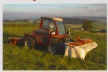
Terratrac Aebi TT105: Neuer kompakt gebauter Hanggeräteträger mit mechanischem Fahrantrieb.
