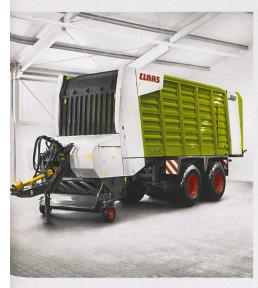
Neu im Programm von CLAAS findet sich ein auf den ersten Blick alltäglicher Ladewagen mit dem Namen CARGOS. Erst bei genauem Hinsehen sieht man, dass der CARGOS einen Zweifachnutzen hat. Das Schneidaggregat, mit Rotor, der 40 Messer besitzt, kann mit wenigen Handgriffen in nur 15 Minuten ausgebaut werden. Der CARGOS kann also im Frühjahr als Ladewagen und im Herbst als Häckseltransporter eingesetzt werden.
