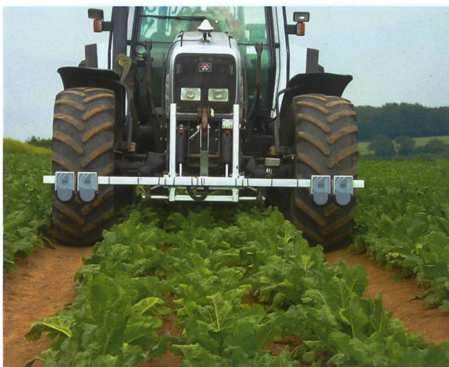
Abb. 5: Parallelfahrssysteme ohne GPS: links Ultraschall-Taster von Reichardt-Steuerungstechnik zur Erkennung von Fahrgassen, rechts Claas-CAM-Pilot zur Lenkung des Hackgeräts zwischen den Reihen.
