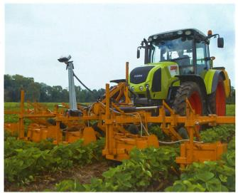
Abb. 5: Parallelfahrsysteme ohne GPS: links Ultraschall-Taster von Reichhardt-Steuerungstechnik zur Erkennung von Fahrgassen, rechts Claas-CAM-Pilot zur Lenkung des Hackgeräts zwischen den Reihen.
