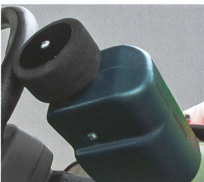
Abb. 7: Möglichkeiten des Lenkeingriffs am Lenkrad: links «Reinhardt RDU» zur Montage am Lenkrad: Mitte «John-Deere AutoTrac Universal» als Austausch-Lenkrad, rechts «Autofarm OnTrac2» zur Montage auf den Speichen des bestehenden Lenkrads.
