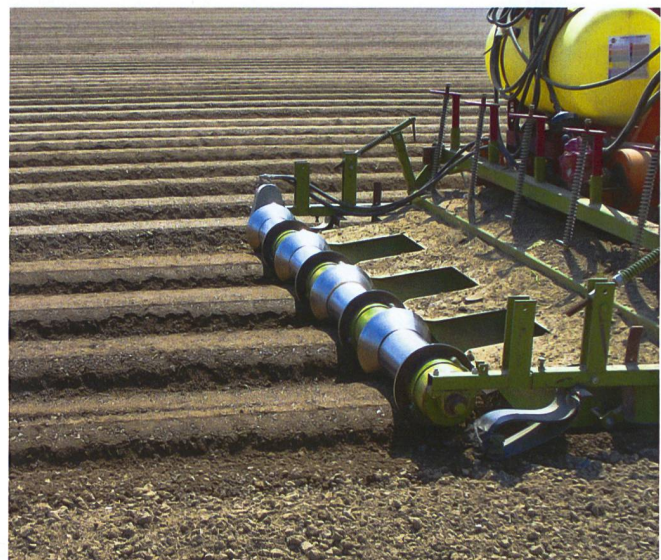
Abb. 4: Nachlaufsteuerungen. Links Trimble TrueTracker, rechts Dammformer mit GPS-gesteuerter Querpositionierung über hydraulischen Verstellrahmen im Dreipunkt.
