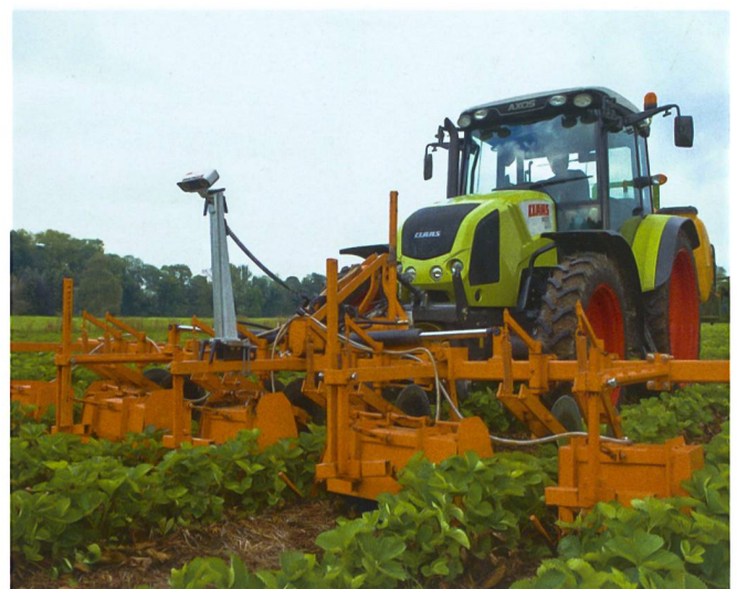
Abb. 5: Parallelfahrssysteme ohne GPS: links Ultraschall-Taster von Reichardt-Steuerungstechnik zur Erkennung von Fahrgassen, rechts Claas-CAM-Pilot zur Lenkung des Hackgeräts zwischen den Reihen.
