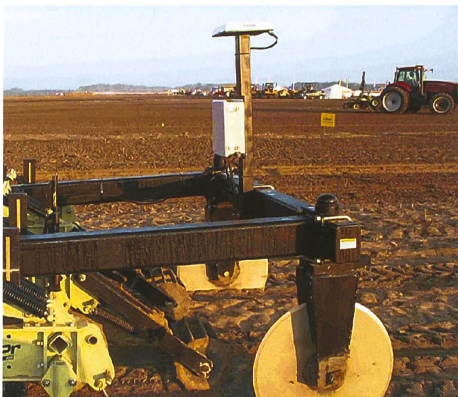
Abb. 4: Nachlaufsteuerungen. Links Trimble TrueTracker, rechts Dammformer mit GPS-gesteuerter Querpositionierung über hydraulischen Verstellrahmen im Dreipunkt.
