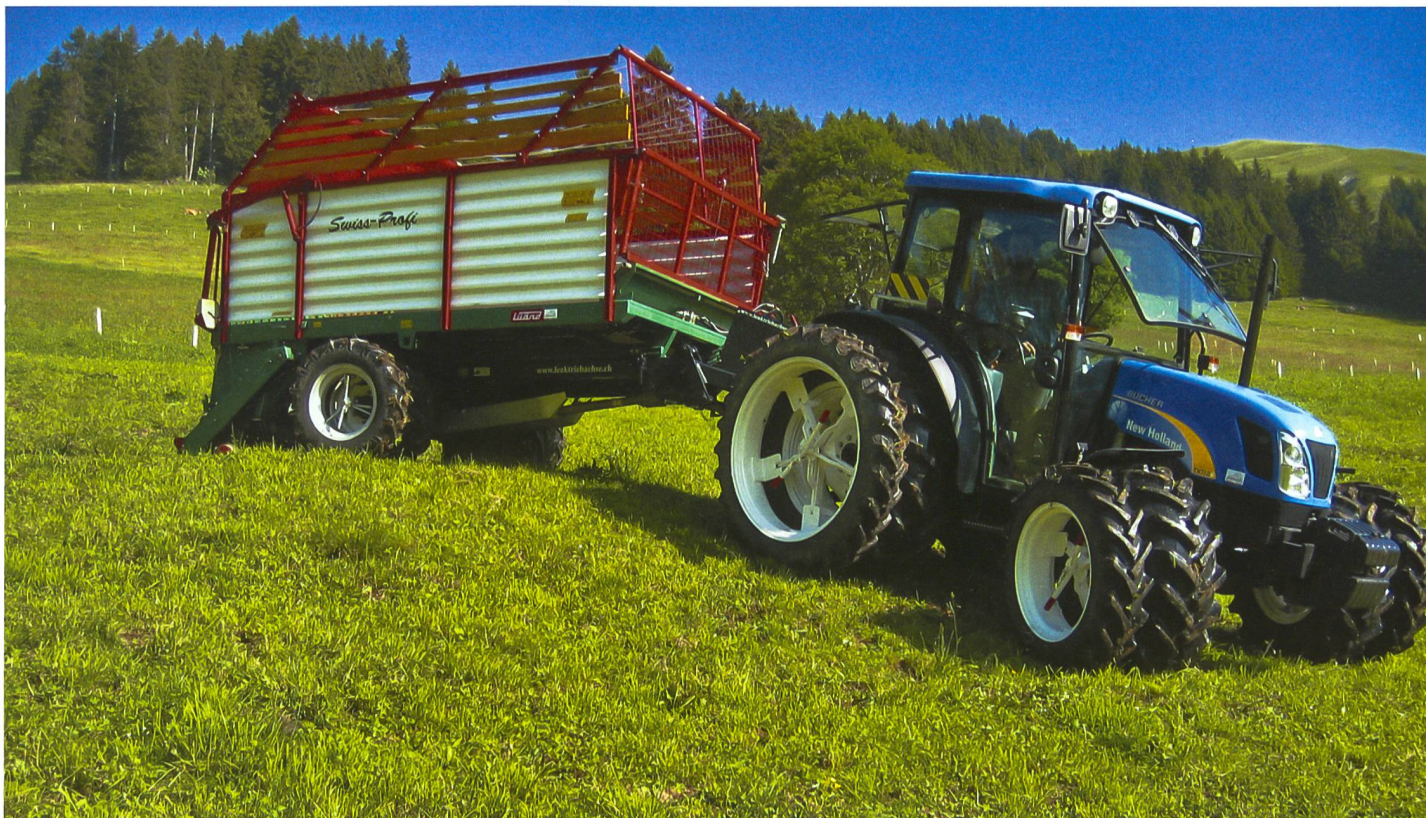
Angepasste und sichere Technik für die Bergmechanisierung: Lenktriebachsanhänger verschieben die Grenzen des Traktoreinsatzes. (Foto: Schmid Landmaschinen, Littau LU)
