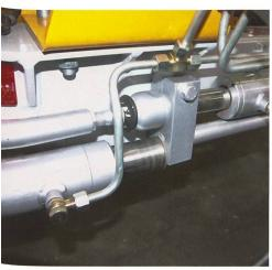
Ein wichtiges Detail beim System Rogenmoser ist das automatische Einschwenken der Räder für die Geradeausfahrt im Falle einer Störung im System. (Foto: Gaël Monnerat)
