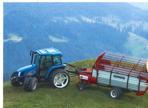
Die Achslenkung verbessert die Manövrierbarkeit. (Foto: Schmid)
