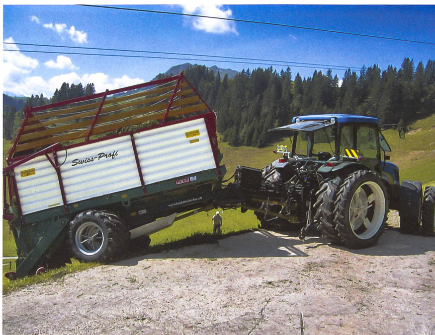
Die Anpassung des Winkels zwischen Deichsel und Traktor sorgt für eine einwandfreie Arbeit im hügeligen Gelände. (Foto: Schmid)
