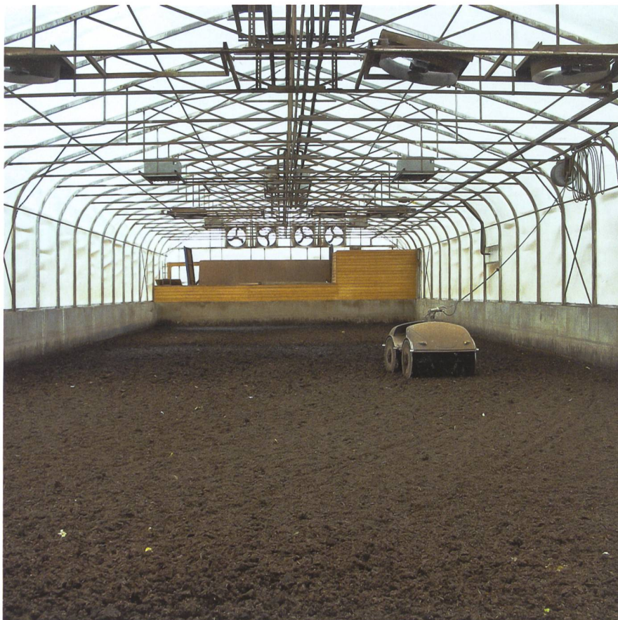
Wärmerückgewinnung zum Trocknen von Gärgut in einem Gewächshaus bezweckt die Herstellung von Gartendünger.
