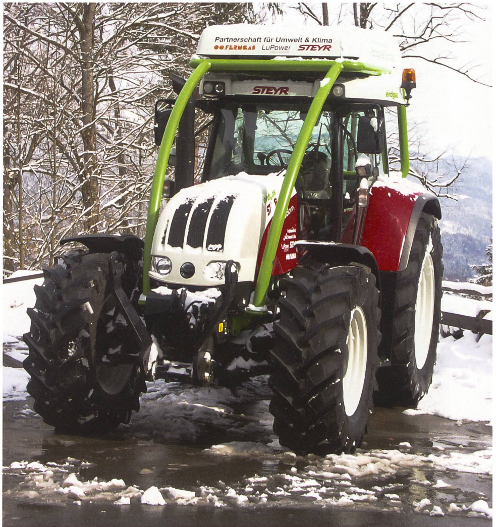
Mit Biogas angetriebener Traktor. (Quelle: Steyr)
