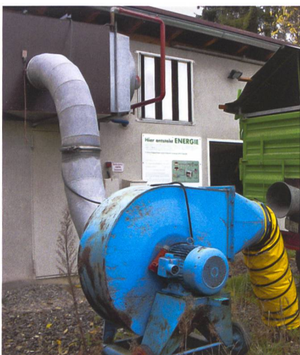
Wärmenutzung aus der Wärmekraftkopplung in einer Getreidetrocknungsanlage.
