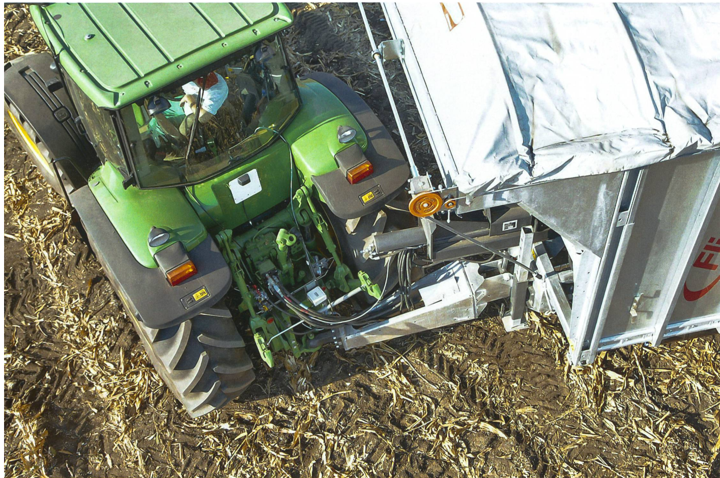
Fliegl-Zwangslenkung «ForCon 2010»: Ein Kreismessinstrument (Gyroskop), das sich in der Box über der Kugelkopfkupplung (Bildmitte) befindet, misst den Kurvenradius und in der Folge den Einschlagwinkel als Mass für die Drehgeber beziehungsweise die über Hydraulikzylinder lenkbaren Tridem-Achsen. (Werkfoto)
