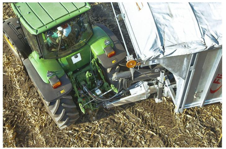
Fliegl-Zwangslenkung «ForCon 2010»: Ein Kreiselmessinstrument (Gyroskop), das sich in der Box über der Kugelkopfkupplung (Bildmitte) befindet, misst den Kurvenradius und in der Folge den Einschlagwinkel als Mass für die Drehgeber beziehungsweise die über Hydraulikzylinder lenkbaren Tridem-Achsen. (Werkfoto)
