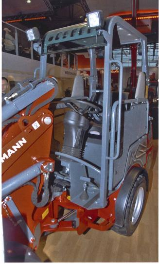
Hoflader ab Baujahr 2010 dürfen nur noch mit geprüftem Fahrerschutz in Form einer Kabine verkauft werden. Gemäss Gefährdungsbeurteilung ist deshalb eine Rückhaltevorrichtung erforderlich, ein Sicherheitsgurt reicht nicht.
