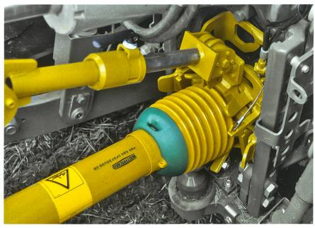
Schnellkupplung: Für zapfwellengetriebene Anbaugeräte mit wenig Abstand und häufigem Wechsel bietet das System Power-Lock eine grosse Erleichterung.
