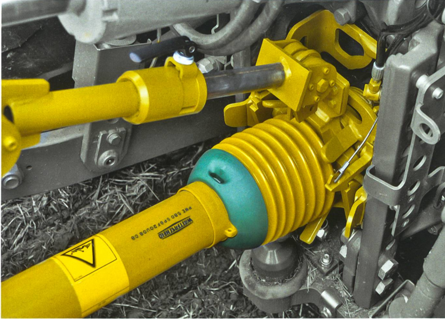
Schnellkupplung: Für zapfwellengetriebene Anbaugeräte mit wenig Abstand und häufigem Wechsel bietet das System Power-Lock eine grosse Erleichterung.
