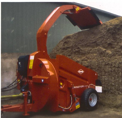
Polyvalent einsetzbare Maschinen: Sie stehen nicht nur bei der Entnahme und bei der Verteilung des Futters im Einsatz, sondern auch für die Einstreuarbeit in Laufställen.
