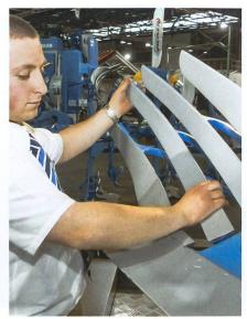
Streifenrister aus Spezialstahl, die bei der Montage nicht mehr geschraubt, sondern lediglich eingehängt werden.
