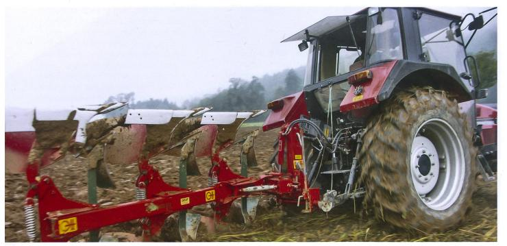
Bruchsicherungen werden in unterschiedlichen Ausführungen angeboten. Mit der richtigen Auswahl können Geld und Gewicht gespart werden. (Bild: Ueli Zweifel)
