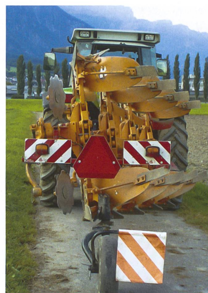
Mehrscharpflüge verdecken immer die Heckleuchten des Traktors, folglich sind sie entsprechend mit einer Beleuchtung auszurüsten. (Bilder: Ruedi Hunger)
