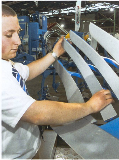
Streifenrister aus Spezialstahl, die bei der Montage nicht mehr geschraubt, sondern lediglich eingehängt werden.
