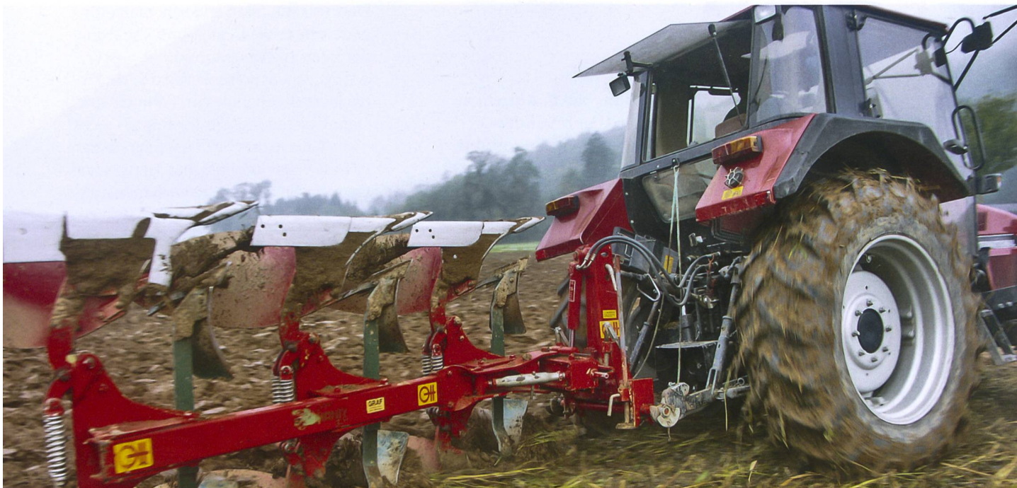
Bruchsicherungen werden in unterschiedlichen Ausführungen angeboten. Mit der richtigen Auswahl können Geld und Gewicht gespart werden. (Bild: Ueli Zweifel)
