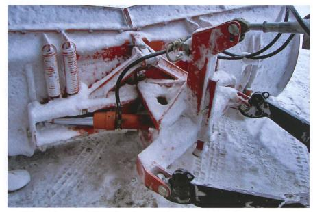
Ausklinkvorrichtung und Schwenkmechanismus für Schneeschild an der Traktorfront. (Bild: Gaël Monnerat)
