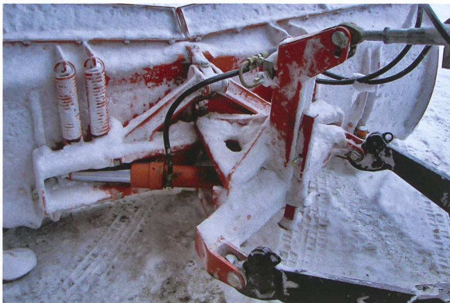
Auslinkvorrichtung und Schwenkmechanismus für Schneeschild an der Traktorfront. (Bild: Gaël Monnerat)
