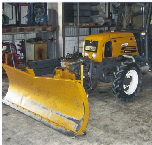
Kleinere Traktoren eignen sich gut für die Schneerräumung auf Plätzen und engen Strassenverhältnissen.
