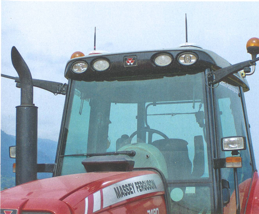
Das Leica mojoGlide ist ein Zweifrequenz-Autolenksystem, mit dem eine Spur-zu-Spur-Genauigkeit zwischen 15 und 25 cm ohne Verwendung einer Basisstation möglich ist. (Bilder: Ruedi Hunger)
