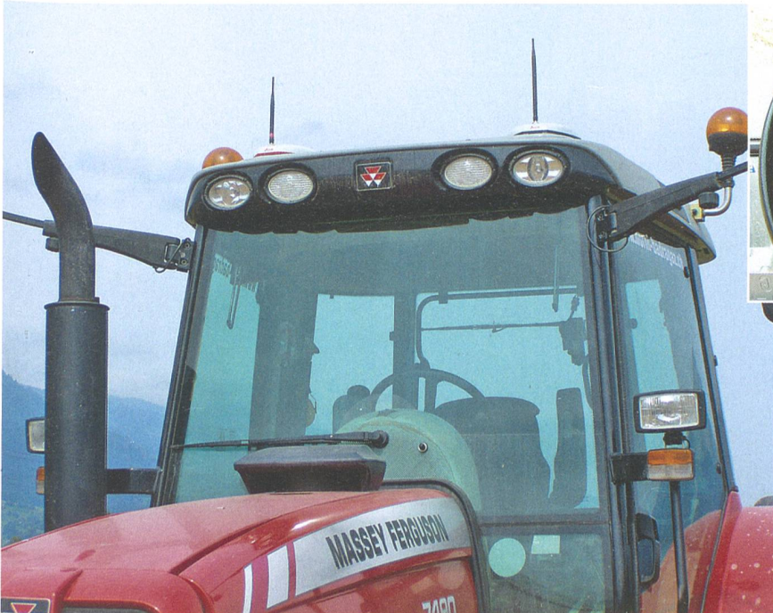
Das Leica mojoGlide ist ein Zweifrequenz-Autolenksystem, mit dem eine Spur-zu-Spur-Genauigkeit zwischen 15 und 25 cm ohne Verwendung einer Basisstation möglich ist. (Bilder: Ruedi Hunger)
