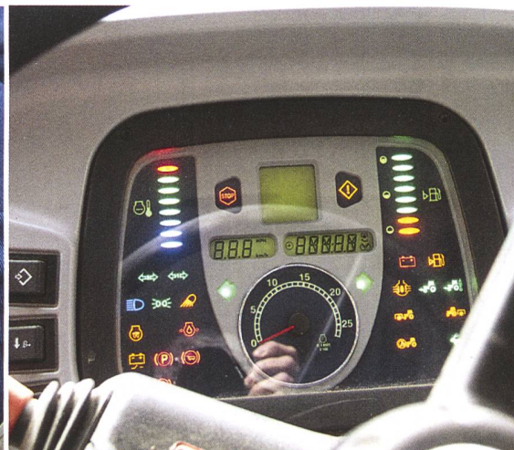
Auf dem neuen Funktionsdisplay werden die Betriebszustände analog oder digital angezeigt.
