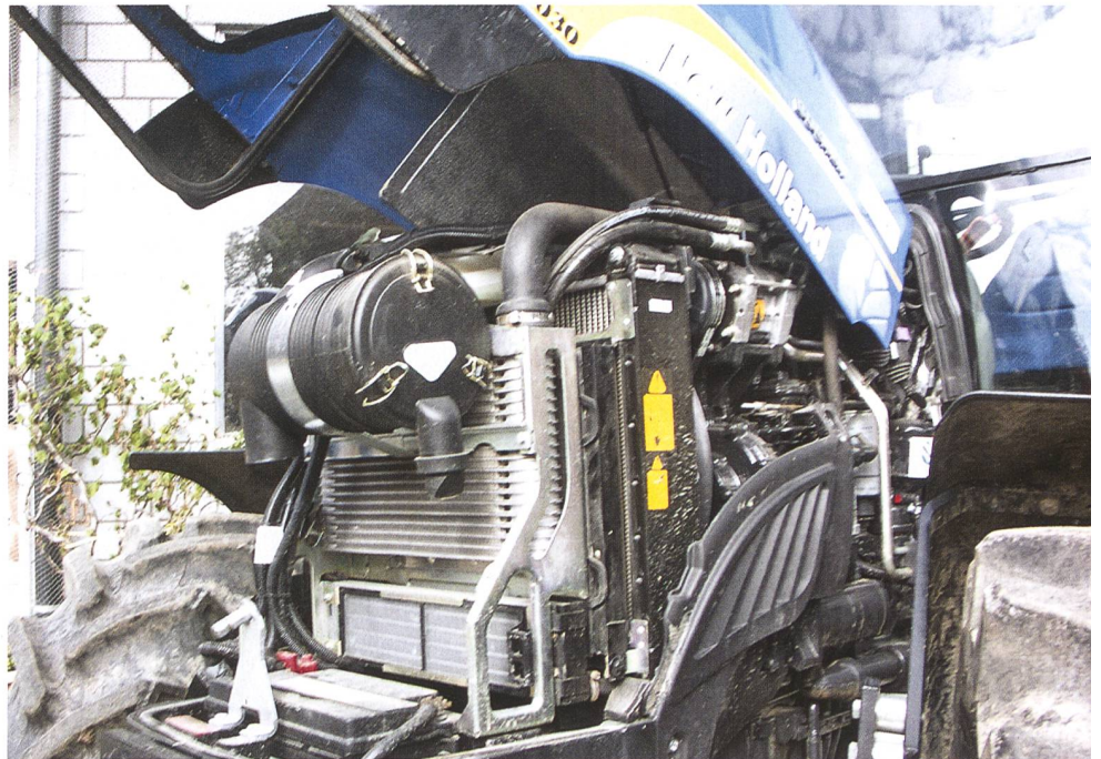
Neuer IVECO F5C 4 Zylinder-Turbomotor mit Ladeluftkühlung und interner Abgas-Rückführung. Im Test bestätigt sich die Optimierung von hoher Leistungsbereitschaft, tiefem Treibstoffverbrauch und Einhaltung der Abgasvorschriften. (Bilder: Ueli Zweifel)
