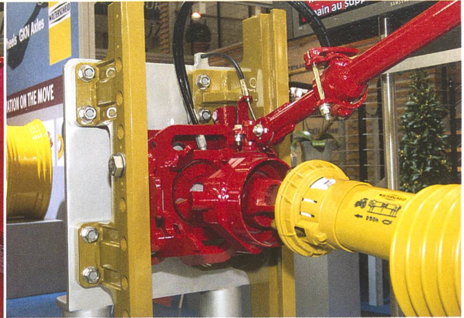
Automatisches Kupplungssystem PowerLock für das sichere Ankuppeln von Gelenkwellen, ohne vom Traktor zu steigen. Das System wurde von GKN Walterscheid in Zusammenarbeit mit Fendt und Pöttinger entwickelt.
