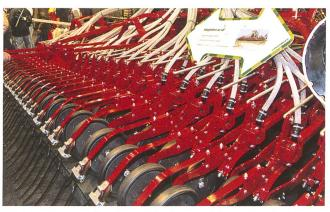
Pöttinger Aerosem für eine präzise Saatgutablage, mit gelenkiger Verbindung für eine optimale Bodenanpassung.
