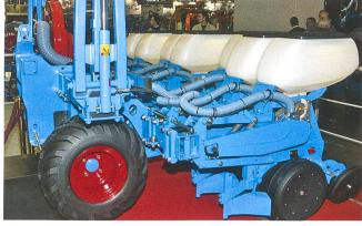
Einzelkornsägerät Monosem mit sieben Aggregaten (hochklappbar) für frei wählbare Reihenabstände.
