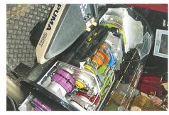
Herzstück des PUMA CVX ist ein stufenloses Getriebe mit vier Fahrbereichen und Doppelkupplungstechnik. Der Motor leistet zwischen 167 und 224 PS und erreicht 250 PS Überleistung.
