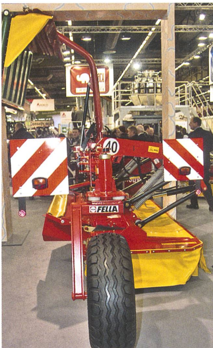
Fella Mähauflbereiter SM 311 Trans RC mit nur 90 PS Leistungsbedarf für Dreipunktanbau mit Radabstützung und optionalem Seitenförderband. Die Scheiben sind leicht austauschbar, weil ihr Antrieb über eine Sechskantstange erfolgt und die Abmessungen machen die Strassenfahrt problemlos.
