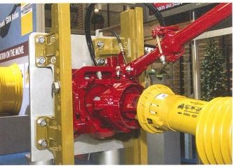
Automatisches Kupplungssystem PowerLock für das sichere Ankuppeln von Gelenkwellen, ohne vom Traktor zu steigen. Das System wurde von GKN Walterscheid in Zusammenarbeit mit Fendt und Pöttinger entwickelt.
