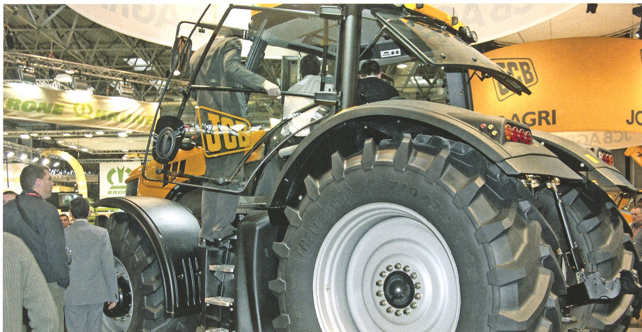
JCB Fastrac 7270 mit allen Attributen des Ackerschleppers. Hubkraft hinten 9 Tonnen, vorne 3,5 Tonnen. (Bilder: Ueli Zweifel)
