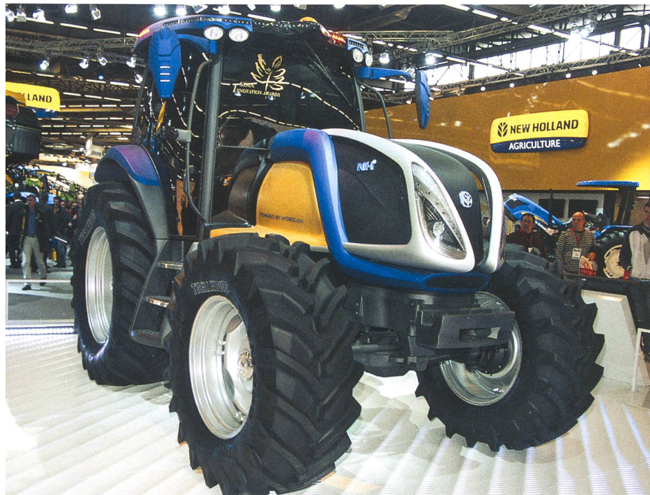
Futuristischer New Holland T6000, in neuem Design und elektrisch betrieben. Die Energie kommt aus Brennstoffzellen, die mit Wasserstoff funktionieren.
