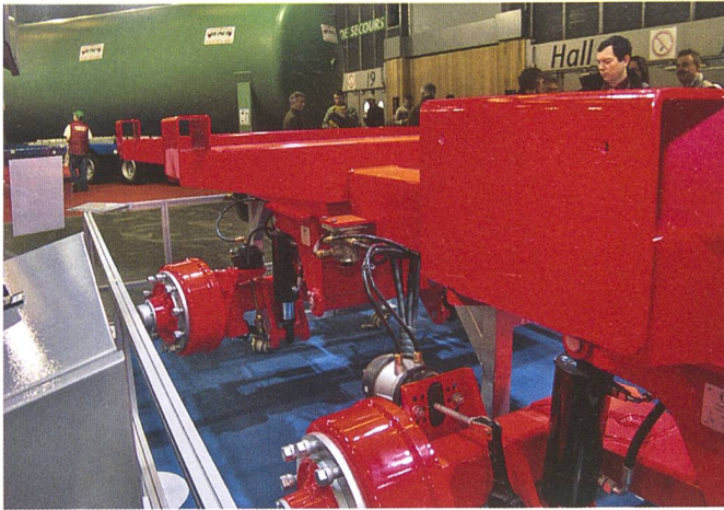
GKN-Automotive stellte ein Fahrwerk aus dem Werk in Telford (GB) aus. Es verfügt über hydraulisch unterstützte Achsaufhängungen und konstruktive Besonderheiten, die Einsparungen bei den Wandstärken der Stahlträger bringen, was nicht nur das Leergewicht verringert, sondern auch im Sinne der Ressourcenschonung sinnvoll ist.
