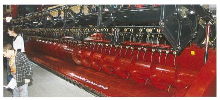
Case IH ist auf Axial-Flow-Mähdrescher spezialisiert. Durch Rotorvergrösserung soll sich auch die Strohqualität verbessern. Elektronik und viele mechanische Faktoren, u.a. eine stufenlos anpassbare Verlängerung des Schneidwerkstisches, erhöhen die Ernteleistung.
