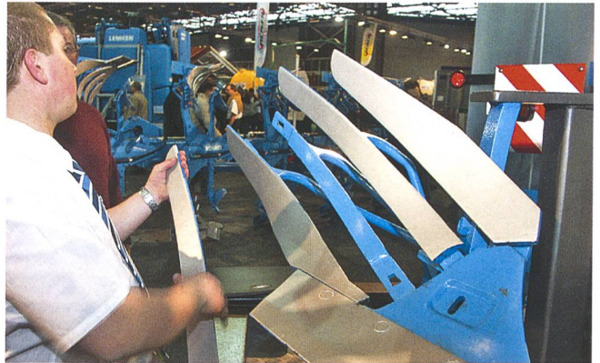
Lemken schlägt ein werkzeugloses Auswechseln einzelner Elemente einer Streifenriester vor.
