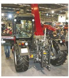
Im Multipack: McCormick und Landini Tele(skoplader)Trac(tor) mit Rückfahreinrichtung.
