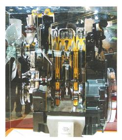
Neue Motortechnik: Alles spricht von Common-Rail, Abgasrückführung, Ad Blue usw. Es gibt aber auch Motoren, die mit mechanisch-hydraulischer Einspritzverstellung und höheren Drücken die neuen Abgasnormen erfüllen, z. B. der wassergekühlte 3-Zylinder-Motor mit Turbolader und Ladeluftkühlung, hergestellt im Same-Werk in Treviglio. Der schlanke Aufbau eignet sich für enge Verhältnisse in Schmalspurtraktoren (bis ca. 120 PS).
