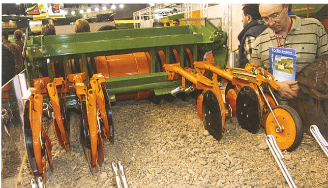
Amazone Roller Drill System: Sätechnik auf Top-Niveau für den Einsatz mit und ohne Grundbodenbearbeitung. Keilringwalze, Scheibenschar, Andruckwalze und Zustreicher sorgen für optimale Keimbedingungen.
