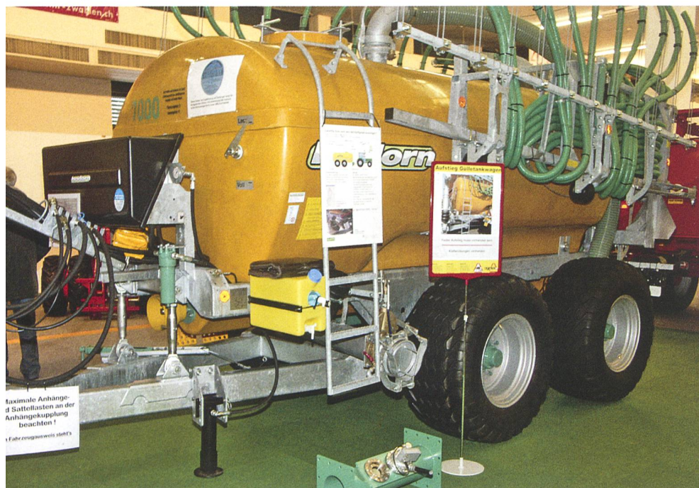
Mit dem Messverfahren Van-Control von Zunhammer werden die Gülleinhaltsstoffe kontinuierlich bestimmt und «online» für eine nährstoffgesteuerte und bedarfsangepasste Gülleausbringung genutzt.
