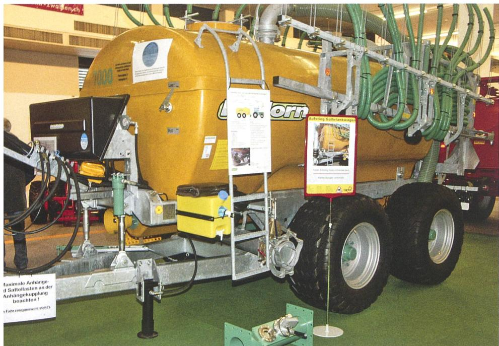
Mit dem Messverfahren Van-Control von Zunhammer werden die Gülleinhaltsstoffe kontinuierlich bestimmt und «online» für eine nährstoffgesteuerte und bedarfsgangepasste Gülleausringung genutzt.
