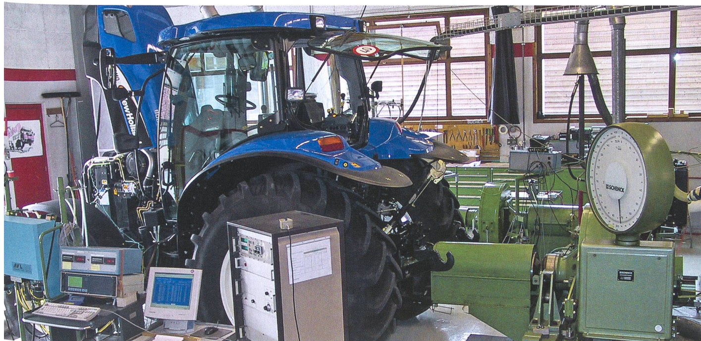
Leistungs- und Abgasmessungen auf dem Prüfstand in Tänikon liefern objektive Messdaten für Traktoren. (Bild: ART)
