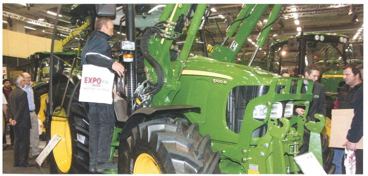
Neue Traktorenbaureihe 5R mit Common-Rail-Motoren und Ladeluftkühlung ersetzt die Baureihe 5020. (Bilder: Ueli Zweifel)
