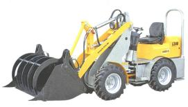
Für enge Platzverhältnisse steht mit dem InTrac 3-Power ein 3-Rad-Hoflader mit 2 Tonnen Hubkraft und einer Hubhöhe von 3,1 m zur Verfügung. Der InTrac 3-Power ist ausgestattet mit hydrostatischem Allradtrieb. Dadurch kann er auch als Geländestapler eingesetzt werden. Durch die Hecklenkung ist das Fahrzeug sehr wendig und kann an Ort drehen.
