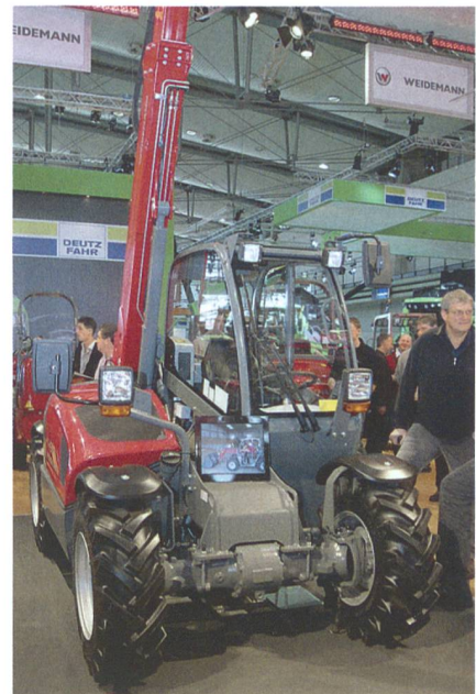
Weidemann T4512 CC35: Durchdachtes Konzept mit äusserst bescheidenem Wenderadius, sogar mit Zapfwelle und Dreipunkthydraulik am Traktorheck erhältlich.
