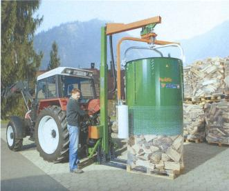
Handliche Verpackung von Stückholz zum Beispiel mit dem PackFix von Posch. (Bild: zVg)
