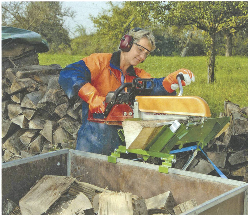
Ablängen mit der Motorsäge: Die Beratungsstelle für Unfallverhütung in der Landwirtschaft (BUL) fordert als Schutzmassnahme einen Sägebock mit Haltevorrichtung. (Bild: BUL)
